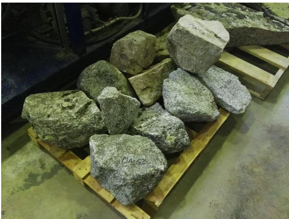
Fig. 2. Bloques seleccionados en cantera para la realización de los ensayos de caracterización
