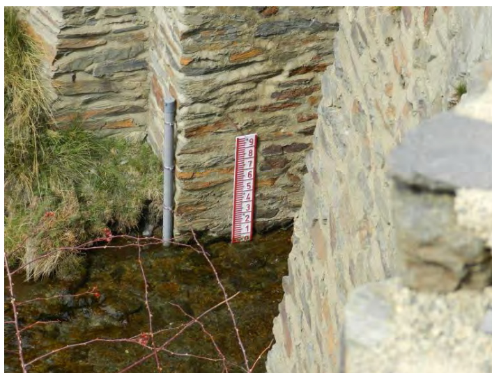
Figura 5.15. Fotografía del sensor y de la escala instalada en el río Chico de Bérchules, en su intersección el camino Sulayr.
