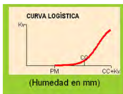
Figura 9.4. Función para el cálculo de la recarga en tránsito según el método de la curva logística implementado en Visual Balan.
