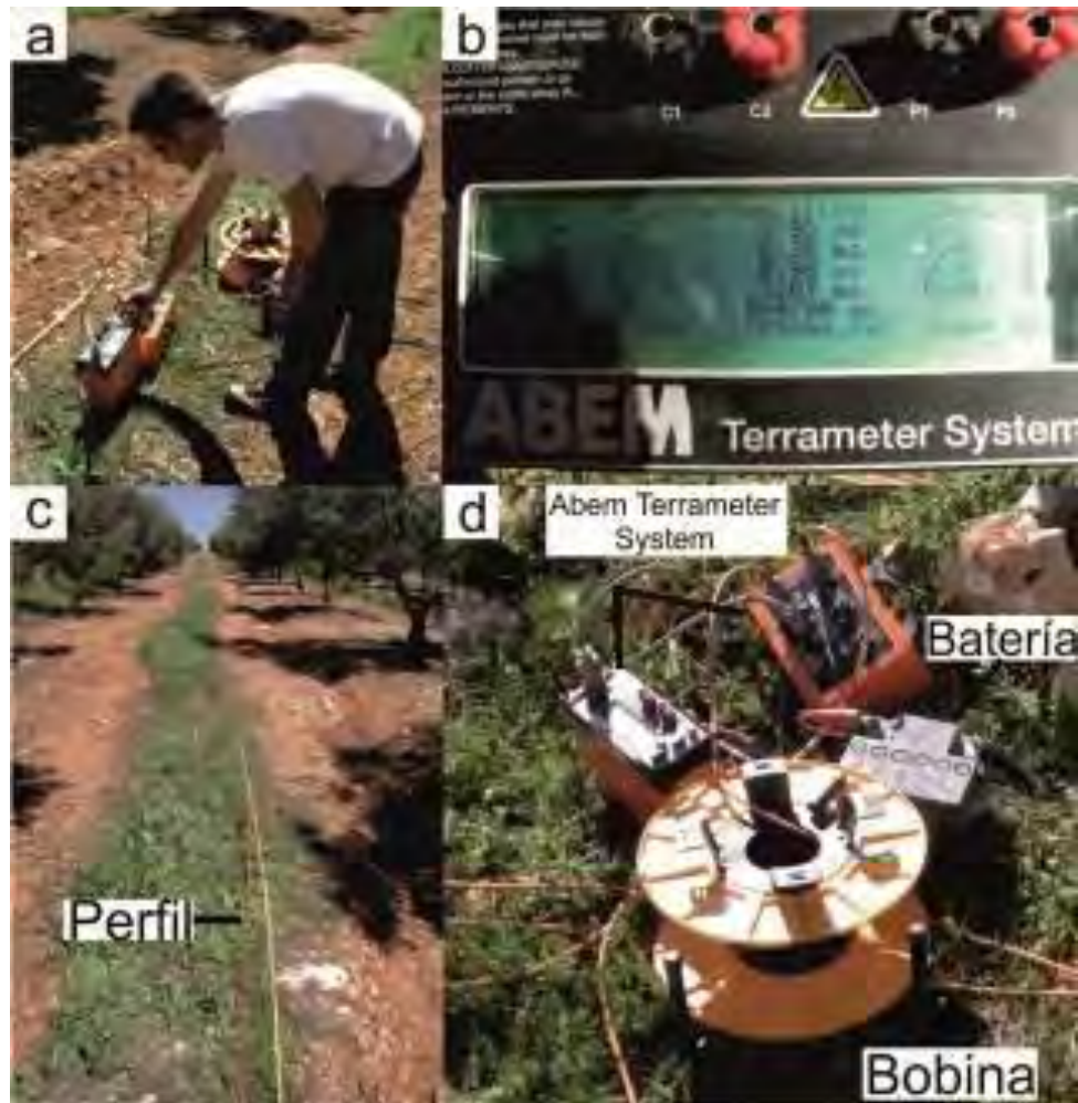
Figura 2.4. Equipo de tomografía eléctrica. (a) Ajuste del equipo para toma de datos. (b) Pantalla Abem Terrameter durante realización de medida. (c) Instalación del perfil (d) Equipo de medida.
