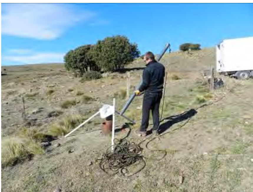
Figura 2.3. Imagen de la barra de PVC macizo empleada para la realización de un ensayo slug en la cuenca del río Bérchules.
