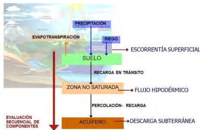
Figura 9.1. Esquema de funcionamiento del Visual Balan.
