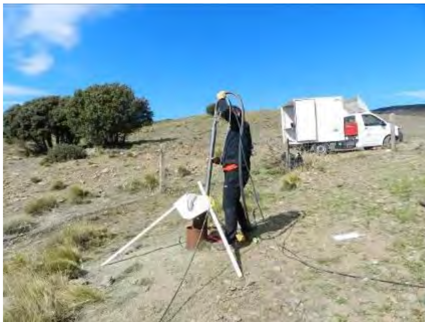
Figura 2.2. Detalle de la instalación fallida del equipo de bombeo del IGME en uno de los pozos de la cuenca del río Bérchules. Una reducción de diámetro en la perforación impedía el descenso del equipo de bombeo.
