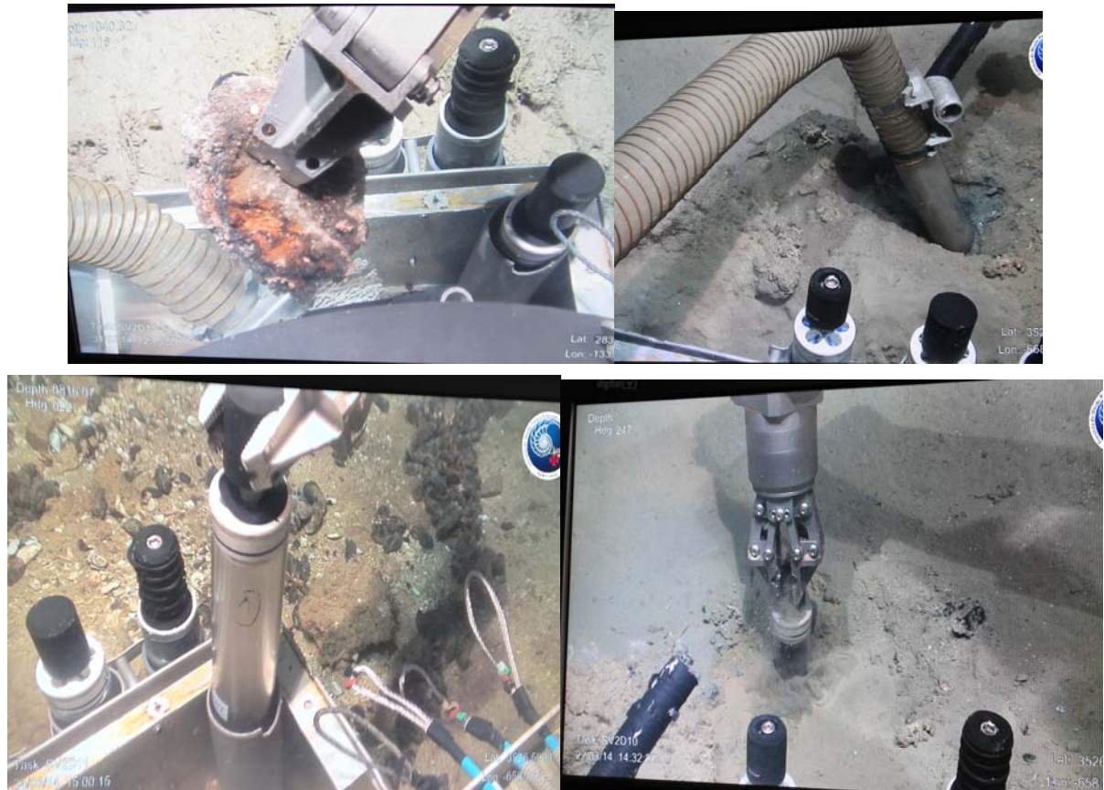
FIGURA 7: Sistemas de muestreo del ROV LUSO: Tomas de rocas, succión y microtestigos.
