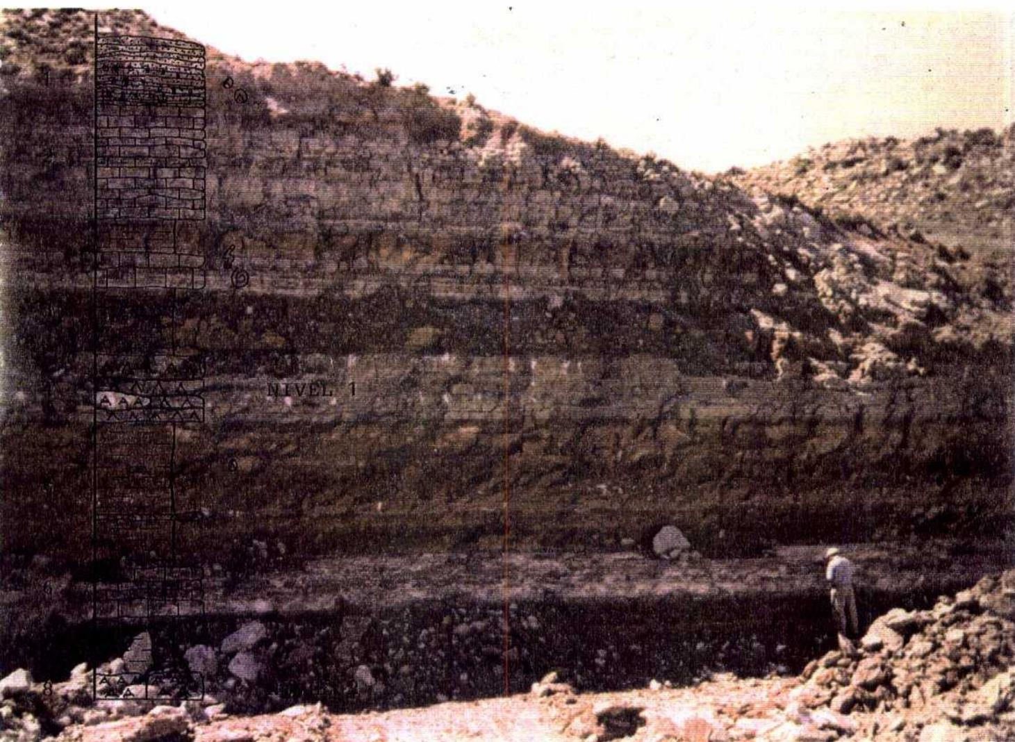
Fig. 42.- Frente de explotación de la cantera de NALSA, en el que se puede observar el corte tipo presente en cotas similares. Obsérvense los dos niveles de alabastro, uno de los cuales (NIVEL 1) no reúne las condiciones de explotabilidad y es denominado por los canteros como "salazón".
