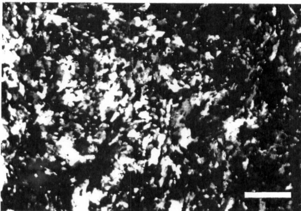
Fig.53B.-Microtextura alabastrina de agregados microcristalinos heterométricos. Muestra S5-1 (sondeo 5). Alabastro de la concesión de NALSA (no explotándose). N.C.; escala: 500  $\mu$ m.
