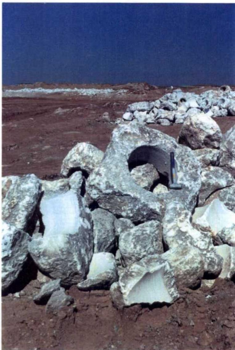
Fig.62.- Plaza de cantera, dentro de la concesión minera Teresa de la empresa NALSA S.A., en la que se muestra el apilamiento de diversos nódulos de alabastro con la morfología tabular paralelepédica.
