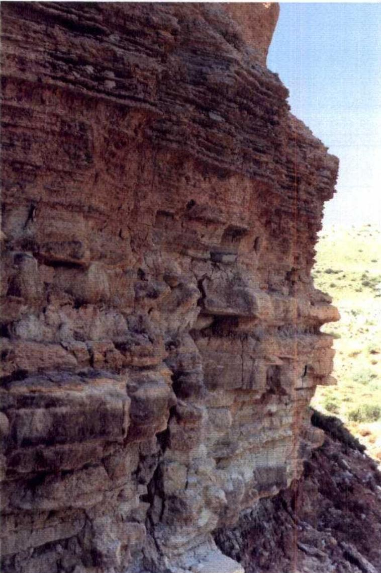
Fig.40.- Corte tipo, en la carretera que asciende al pueblo de Azaila, que está presente por los alrededores y es correlacionable con los frentes de explotación - de las canteras situadas en cotas similares.
