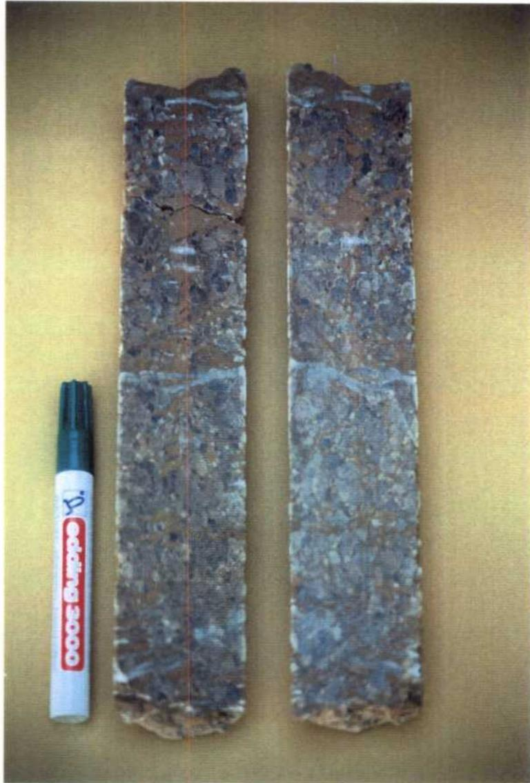
Fig. 51 .- Fragmento de testigo del sondeo N°6 mostrando la textura nodular discontinua. Se aprecian venas de yeso fibroso perpendiculares al eje de perforación del sondeo.
