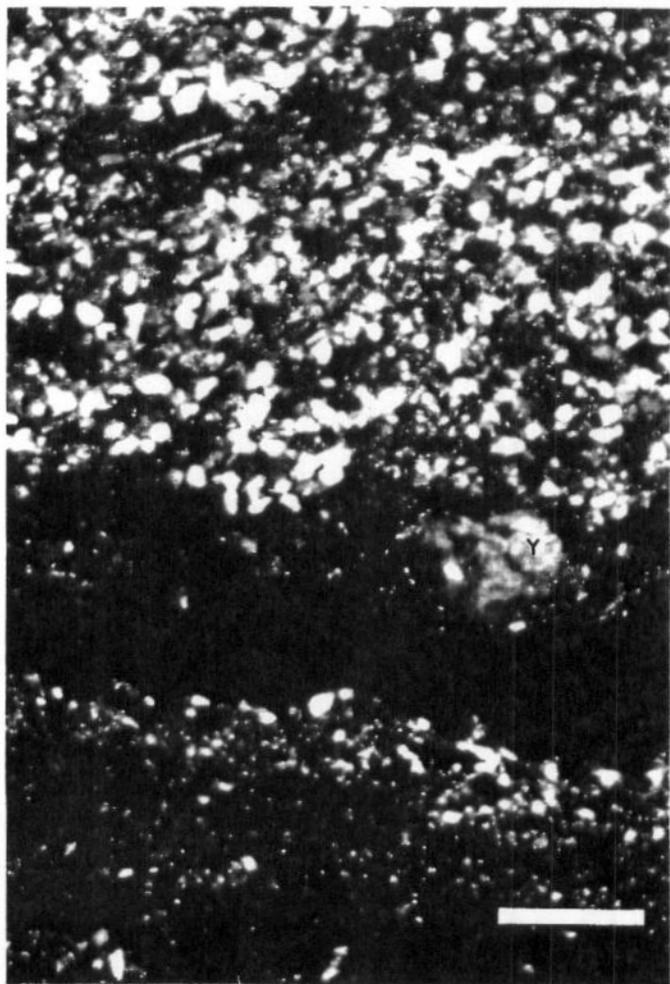
Fig.46.-Limolita calcárea con nódulos de yeso (Y). Muestra LS3-7 (sondeo 3). N.C.; escala: 500  $\mu$ m.
