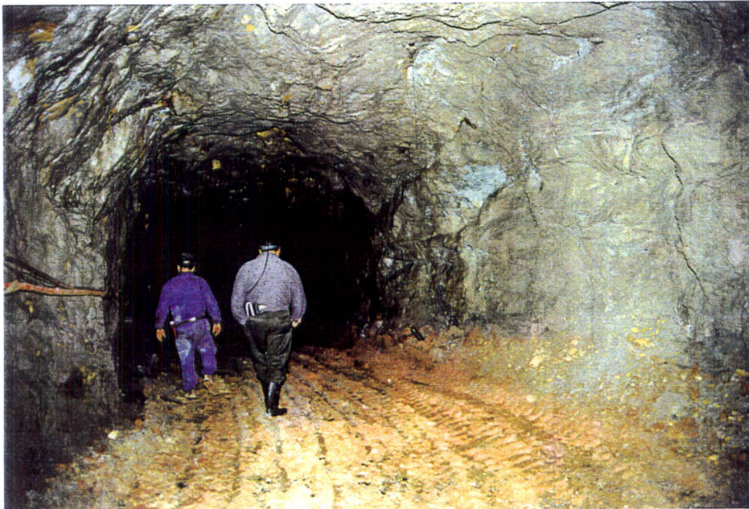
Galería de acceso a los frentes de explotación de espato-flúor.
