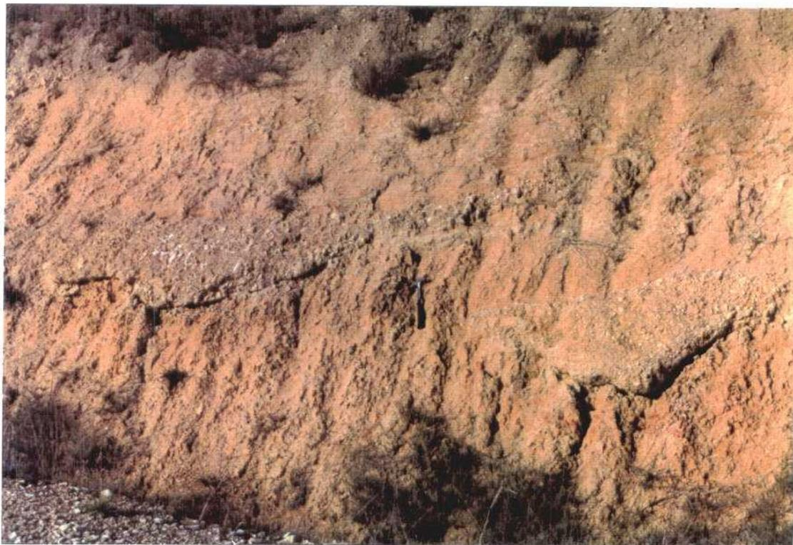
Foto 14.- Arcillas, arcillas limosas y areno-limosas, con intercalaciones de areniscas y conglomerados, en cuerpos canalizados, correspondientes a la unidad 42. Los cantos de los conglomerados son de carbonatos y areniscas cuyo centil, en la localidad donde se ha tomado la foto, es de aprox. 15 cm y la mediana de aprox. 3 cm. Afloramiento situado a unos 1,5 km. al noreste de Ameyugo.
